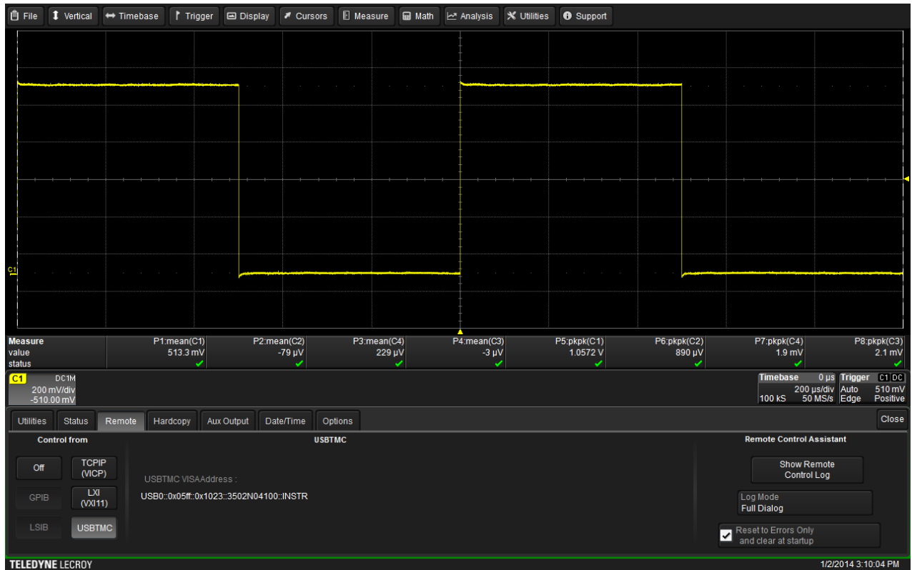
Abbildung 2 – Oberfläche des LeCroy Oszilloskops – Utilities/Remote/Control from auf USBTMC einstellen.
