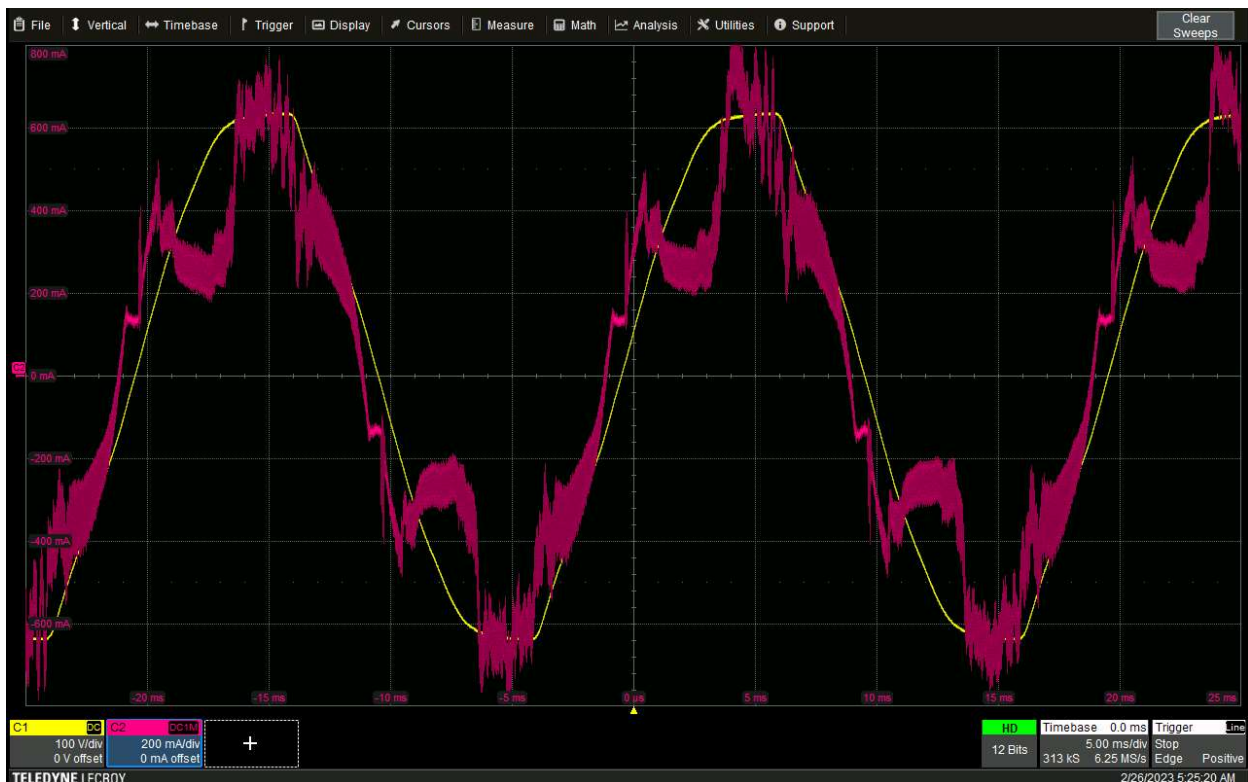
Abbildung 1 - WaveSurfer 4024HD mit C1: Spannung am 230V-Netz; C2: Strom in den Verbraucher.
