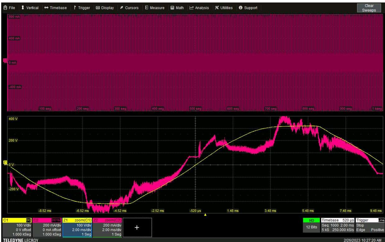
Abbildung 10 - C1-Spannung 1000 Segmente, C2-Strom 1000 Segmente, Z1-Zoom der Spannung Segment 1, Z2-Zoom vom Strom Segment 1.
