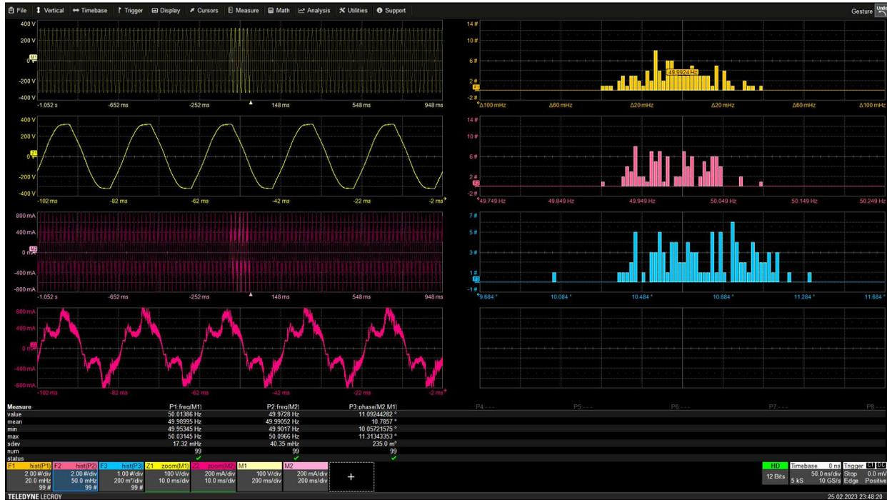
Abbildung 7 - Beispiel-Auswertung der erfassten Kurven von Netz-Spannung und Verbraucherstrom.
