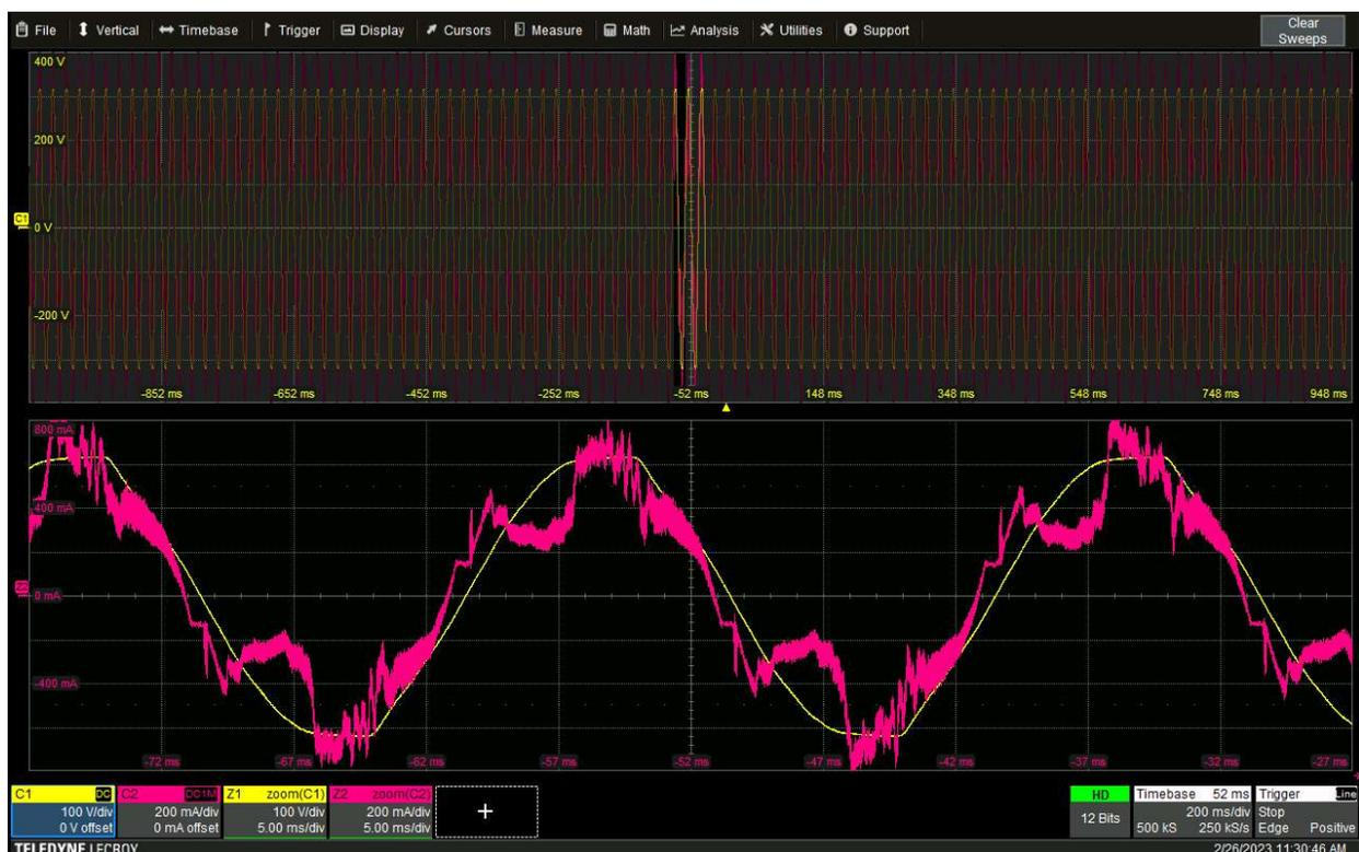
Abbildung 1 - WaveSurfer 4024HD mit einer Datenerfassung von 2s von C1: Spannung am 230V-Netz; C2: Strom in den Verbraucher.
