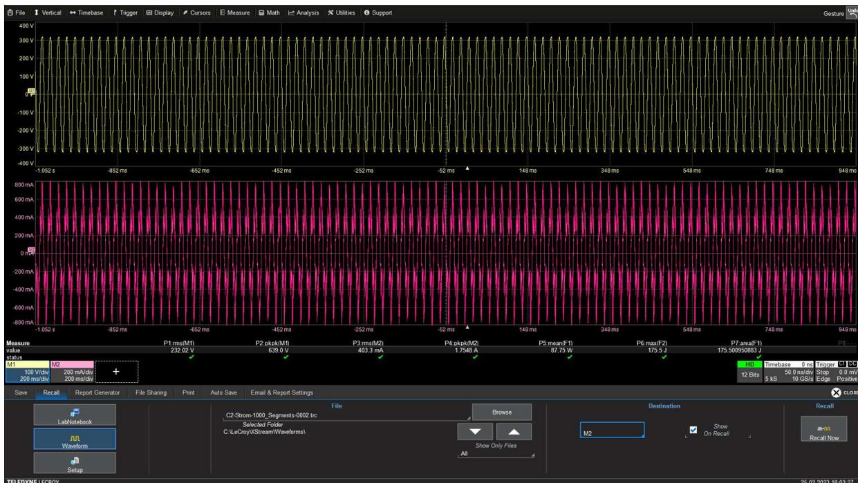
Abbildung 12 - C1-Spannung 1000 Segmente wird in M1 und C2-Strom 1000 Segmente in M2 importiert.
