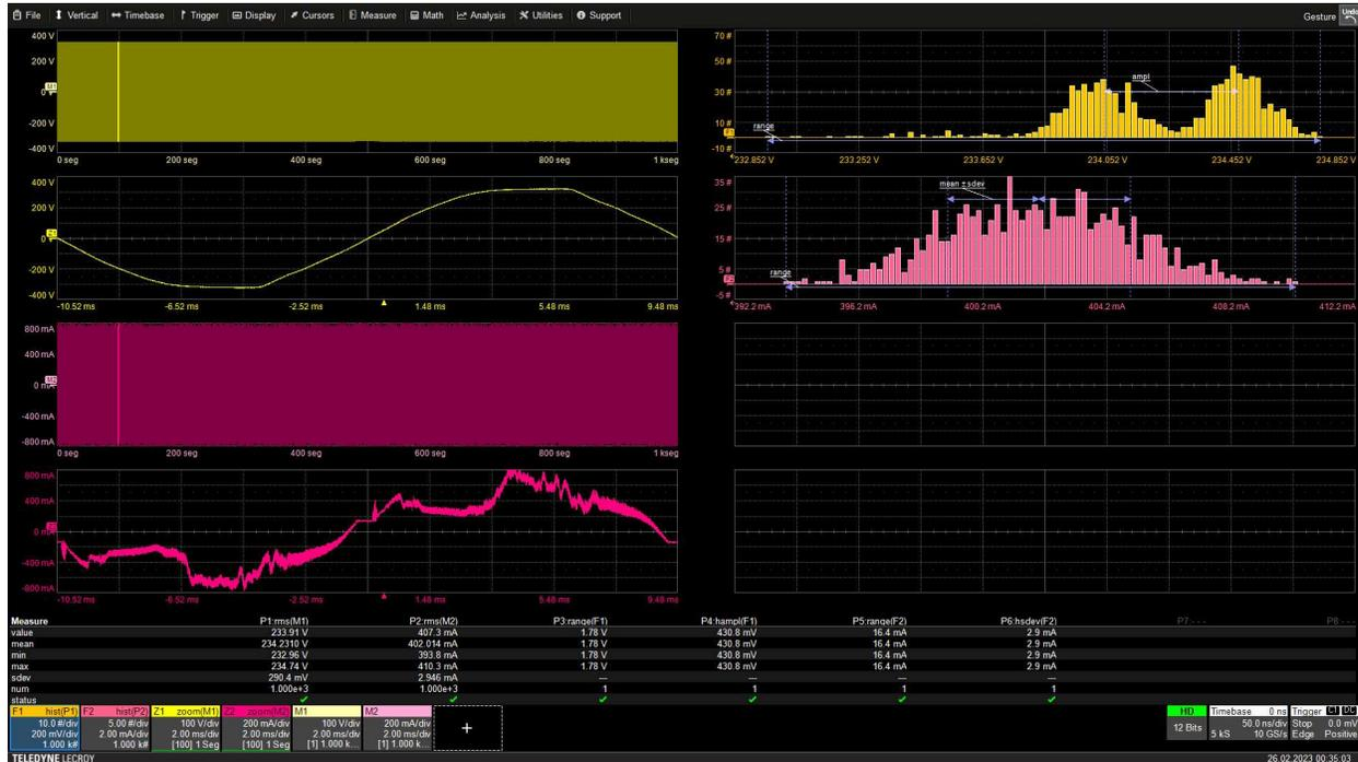
Abbildung 13 - Beispiel-Auswertung der erfassten 1000 Kurven pro Periode von Netz-Spannung und Verbraucherstrom.
