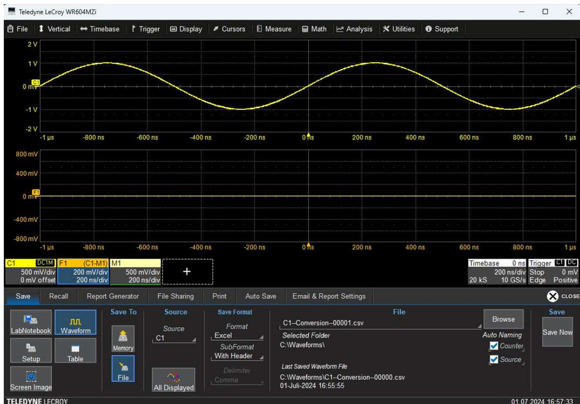
Abbildung 11 – Nur bei identischen Einstellungen der Vertikalen Skalierung, Offset und Einheit funktioniert die Konvertierung perfekt.
