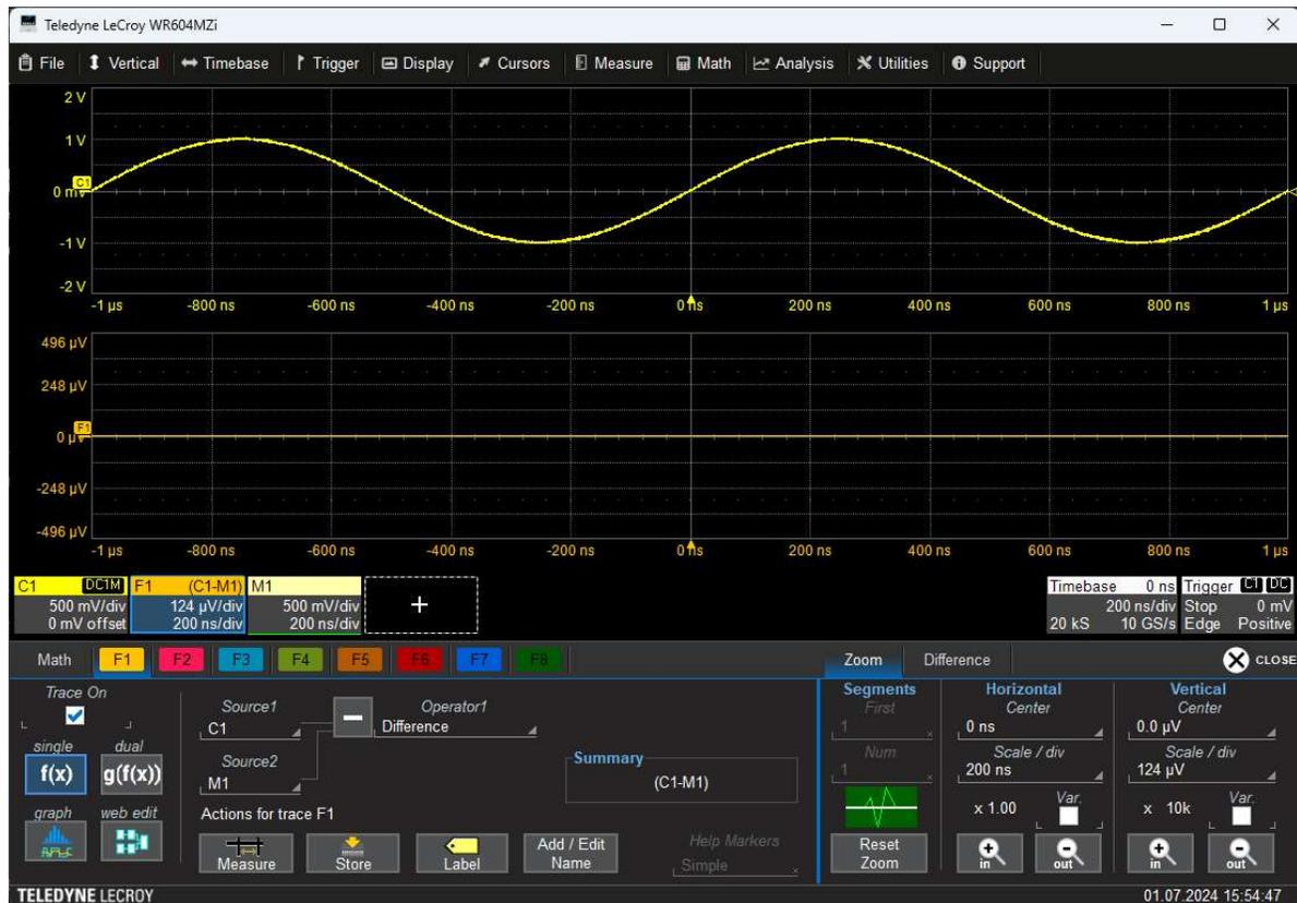
Abbildung 9 – Die Differenz zwischen Original-Kurve und der erzeugten Kurve ist nicht sichtbar.
