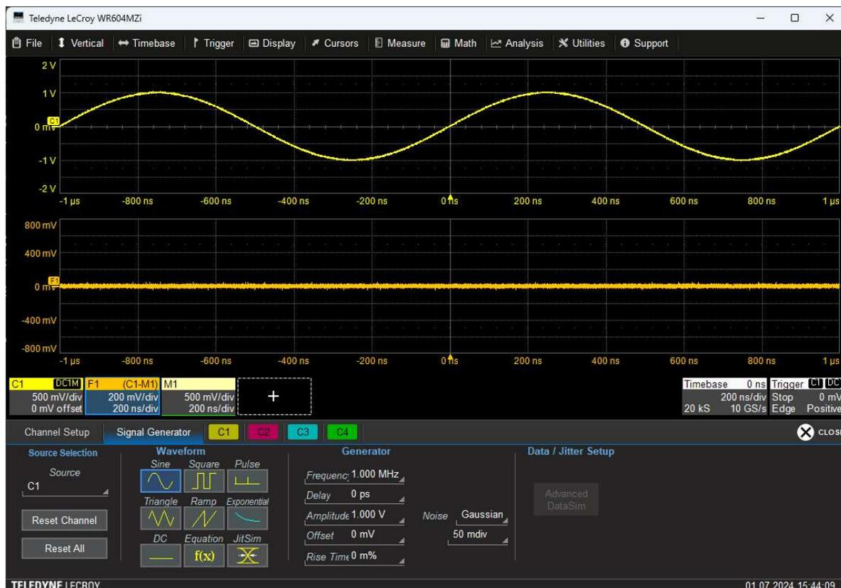
Abbildung 1 – MAUI Studio Pro generiert ein Sinus-Signal mit überlagertem Rauschen.
