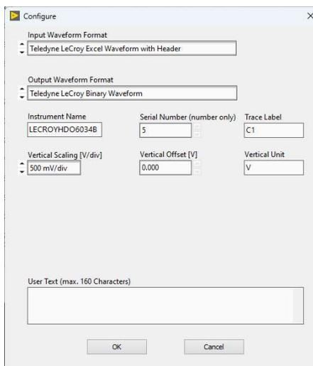
Abbildung 4 – Vertikale Einstellungen müssen dem Konverter mitgeteilt werden.
